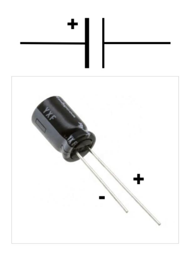
Beim Einbau in eine Schaltung dürfen die beiden Anschlüsse nicht vertauscht werden. Wenn doch, dann wird der Elektrolyt-Kondensator umgekehrt gepolt aufgeladen. Dabei wird das flüssige Elektrolyt zum Kochen gebracht und beginnt irgendwann zu gasen. Das Gas wird irgendwann durch eine Sollbruchstelle im Gehäuse entweichen. Danach ist der Kondensator kaputt.
