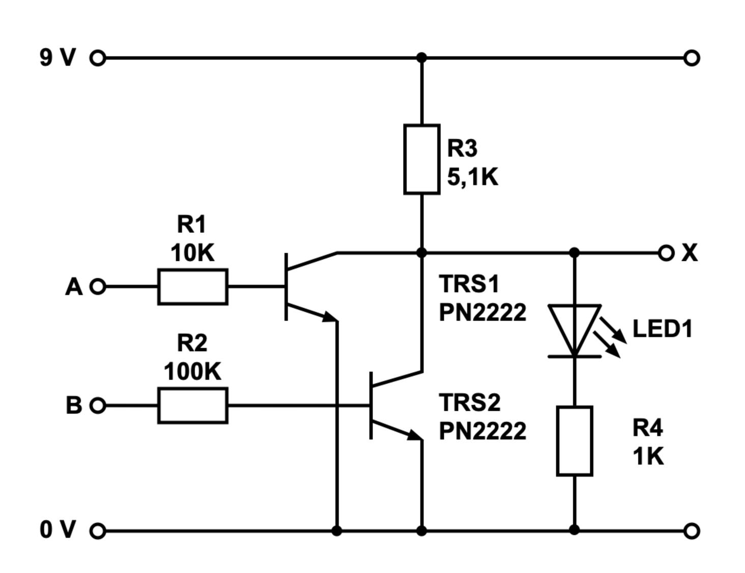
Eine NICHT-ODER-Schaltung (NOR) ist eine Schaltung, deren Funktion auf die Erfüllung einer Bedingung beruht. WENN "Bedingung" erfüllt, DANN "Funktion".
