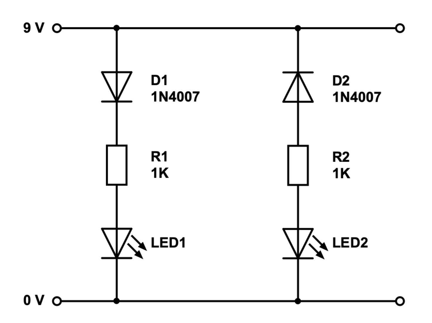
Wir wollen herausfinden, wie sich eine Diode in einem einfachen Stromkreis verhält. Hierzu lässt sich vorab schon mal sagen, dass eine Diode eine Ventilwirkung hat, also den Stromkreis nur in eine Richtung durchlässt. Die Funktion einer Diode ist also von der Polung abhängig. Aber, wie genau wirkt sich das zum Beispiel auf die anderen Bauteile im selben Stromkreis aus? Und wie lässt sich das in einer Anwendung sinnvoll nutzen?
