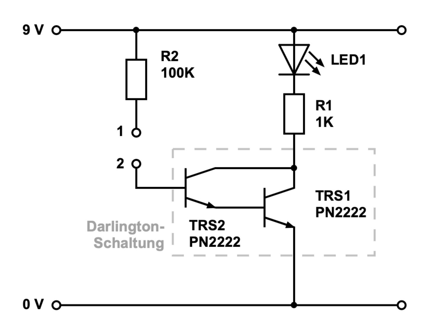
Der Sinn diese Schaltung ist, dass durch den zweiten Transistor der Basisstrom am ersten Transistor verstärkt wird und somit eine höhere Empfindlichkeit erreicht wird bzw. ein geringerer Steuerstrom notwendig ist.
