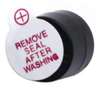
Bei einem Summer muss man in der Regel auf die Polarität achten. Dabei ist der positive Pol mit einem Plus (+) oben auf dem Gehäuse gekennzeichnet. In der Regel ist das Anschlussbein beim Pluspol länger. Die Betriebsspannung der marktüblichen Summer ist von der Farbe des bedruckten Etiketts abhängig. Die Farbe Blau deutet auf 5 Volt hin. Die
