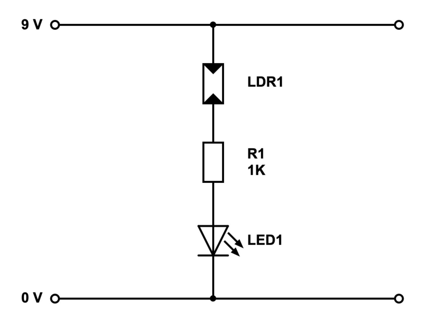
Wir wollen herausfinden, wie sich ein Fotowiderstand, kurz LDR genannt, in einem einfachen Stromkreis verhält. Hierzu lässt sich vorab schon mal sagen, dass der Widerstandswert eines Fotowiderstands von der Helligkeit des einfallenden Lichts abhängig ist. Aber, wie genau wirkt sich das zum Beispiel auf die anderen Bauteile im selben Stromkreis aus? Und wie lässt sich das in einer Anwendung sinnvoll nutzen?
