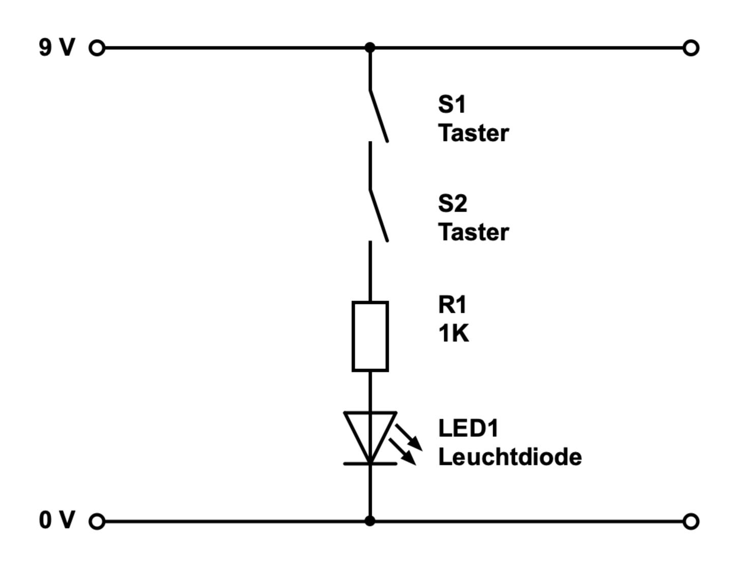
Eine UND-Schaltung ist eine Schaltung, deren Funktion auf die Erfüllung einer Bedingung beruht. WENN "Bedingung" erfüllt, DANN "Funktion".
