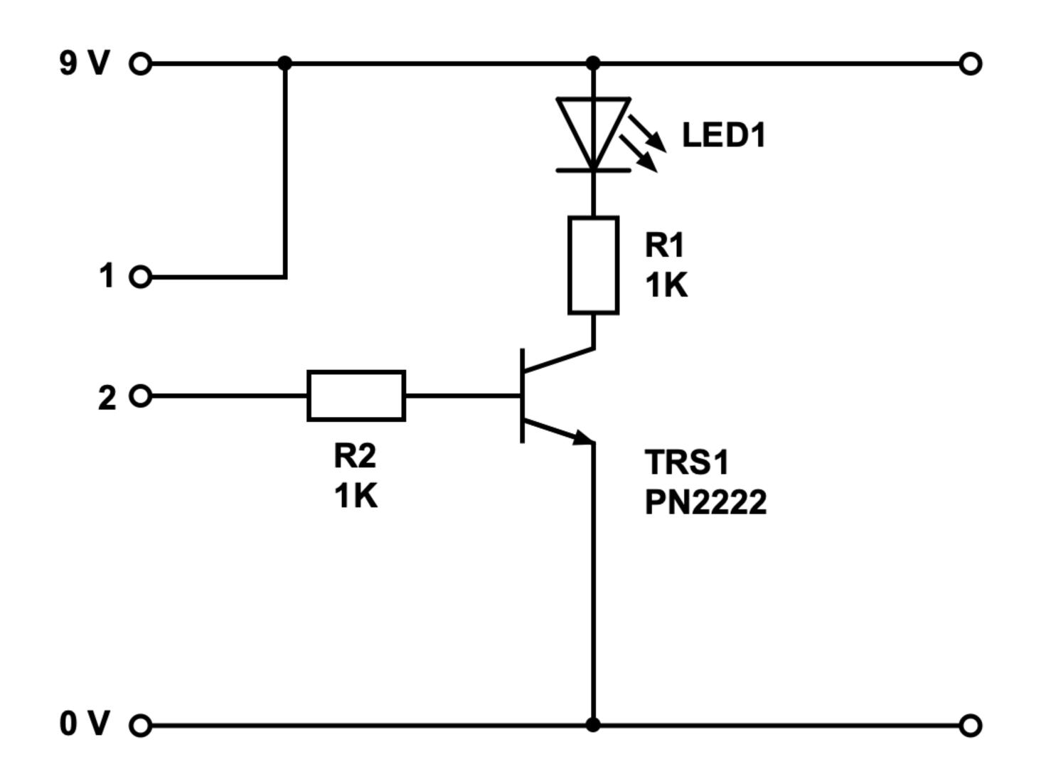
Diese Schaltung kann als einfacher Durchgangsprüfer genutzt werden. Zur Signalisierung eines Stromflusses wird eine Leuchtdiode verwendet.
