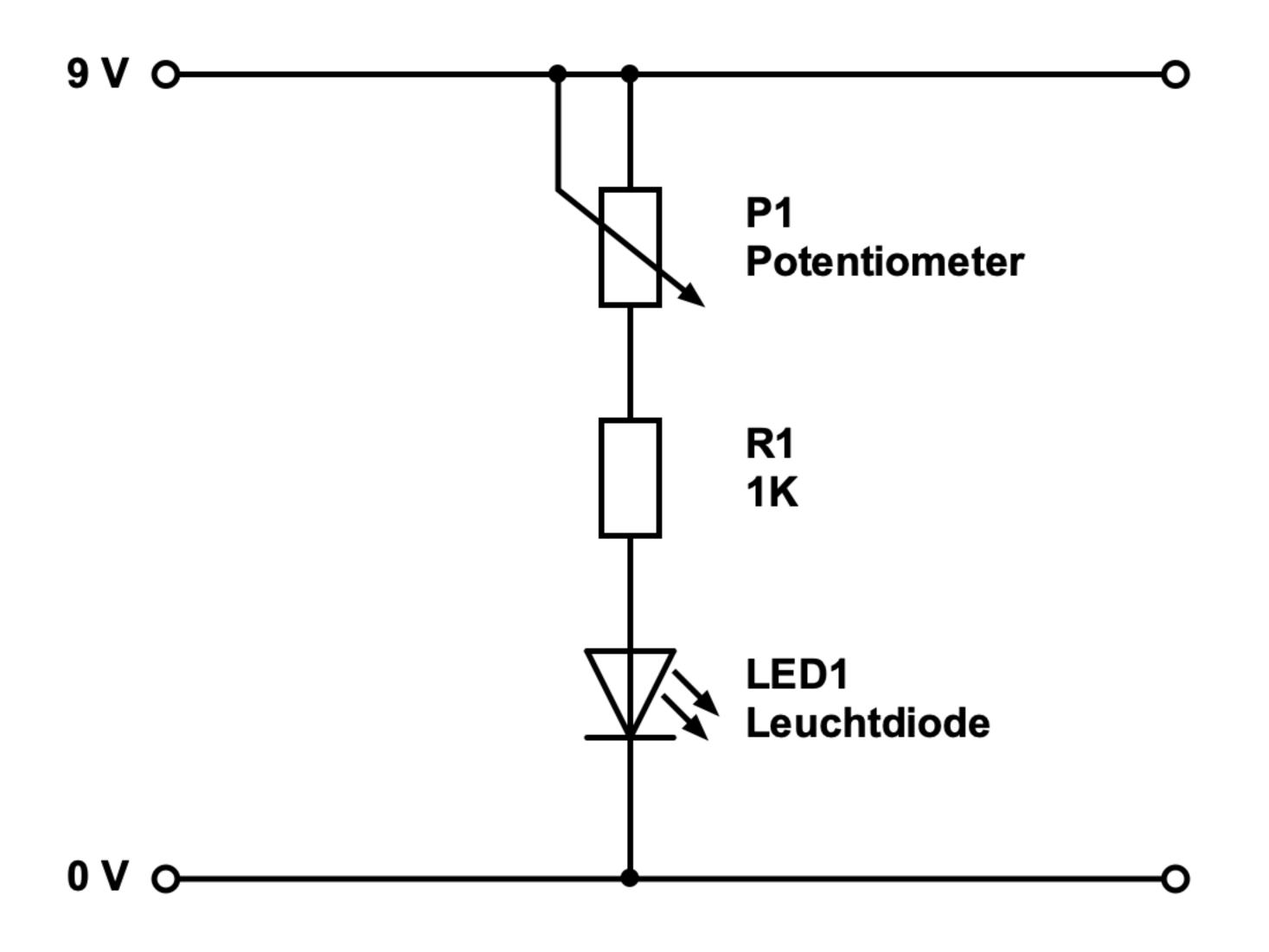
Wir wollen herausfinden, wie sich ein Potentiometer in einem einfachen Stromkreis verhält. Hierzu lässt sich vorab schon mal sagen, dass ein Potentiometer ein einstellbarer Widerstand ist, und man damit den Strom in einem Stromkreis einstellen kann. Aber, wie genau wirkt sich das zum Beispiel auf die anderen Bauteile im selben Stromkreis aus? Und wie lässt sich das in einer Anwendung sinnvoll nutzen?
