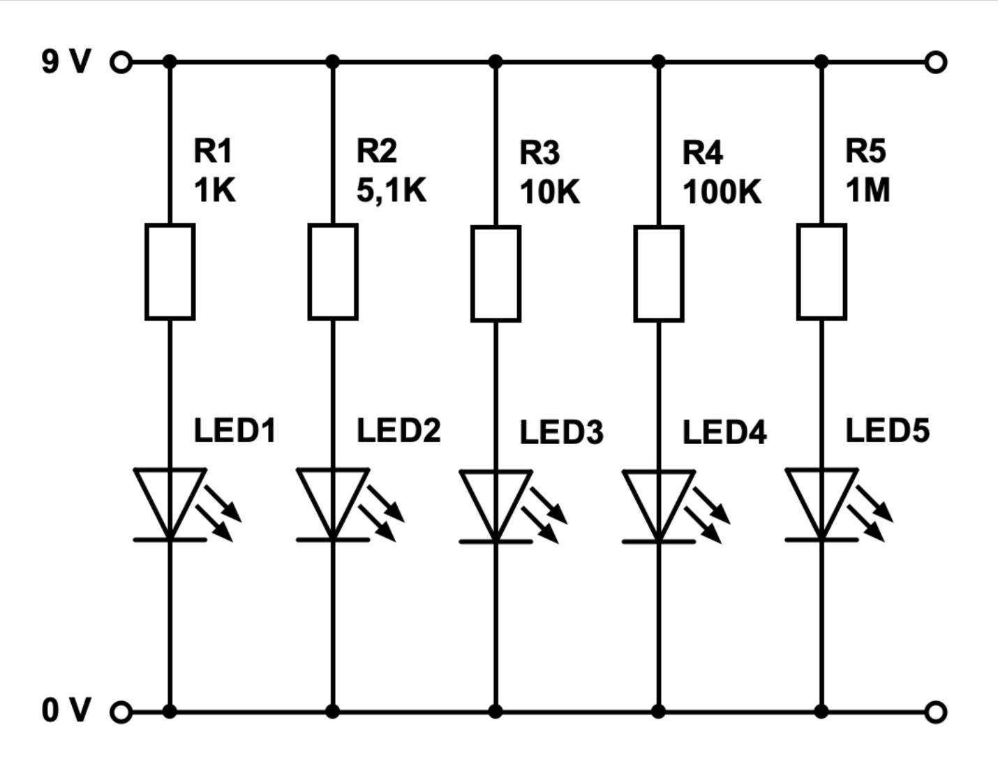
Leuchtdioden müssen immer mit einem Vorwiderstand betrieben werden, damit bestimmte maximale Grenzwerte eingehalten werden. Der Vorwiderstand begrenzt den Strom und daran fällt ein Zuviel an Spannung ab. Sind Strom oder Spannung zu groß, dann geht die Leuchtdiode kaputt.
