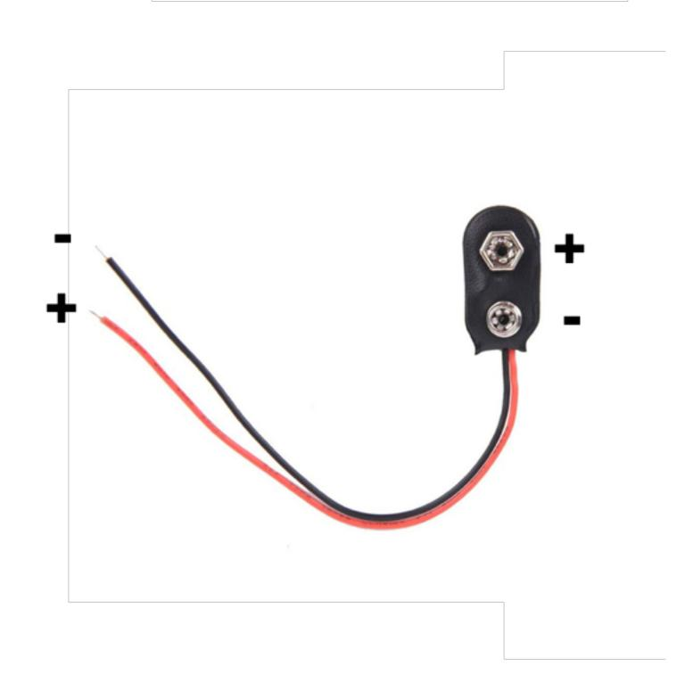
Man sollte darauf achten, dass die beiden Adernenden nicht miteinander in Berührung kommen. Dadurch würde man die beiden Pole der Batterie kurzschließen. Die Batterie kann dabei Schaden nehmen.
