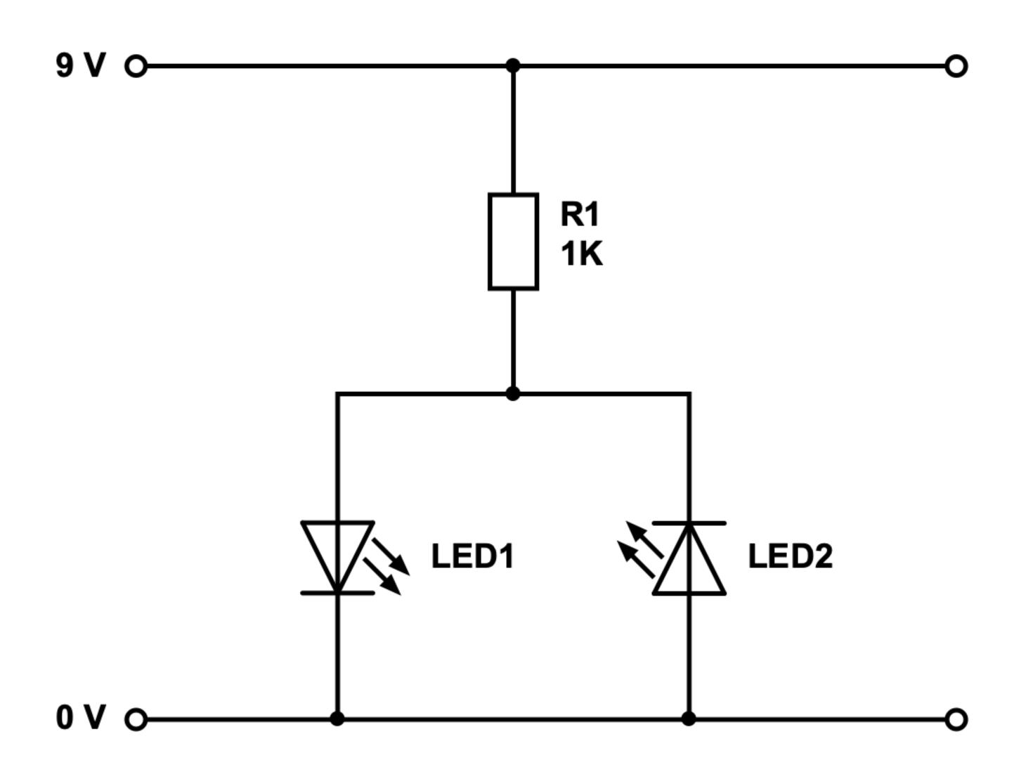
Mit dieser Schaltung kannst Du die Polarität einer Spannungsquelle testen oder eine Polaritätsanzeige für eine andere Schaltung bauen.
