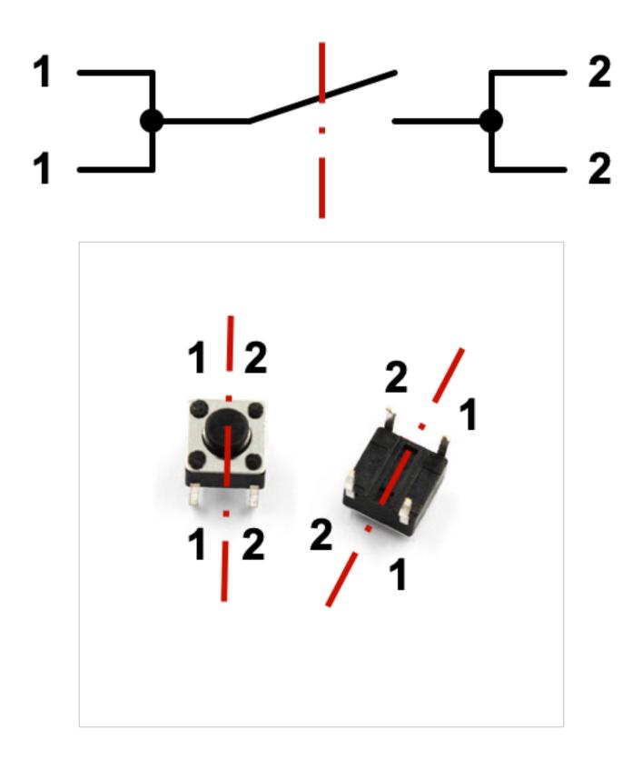
Die im Bild mit 1 und 2 gekennzeichneten Anschlüsse können je nach Bauform an unterschiedlichen Positionen liegen. Welche Anschlüsse zusammengehören, muss man mit einem Durchgangsprüfer oder Widerstandsmessgerät herausfinden.
