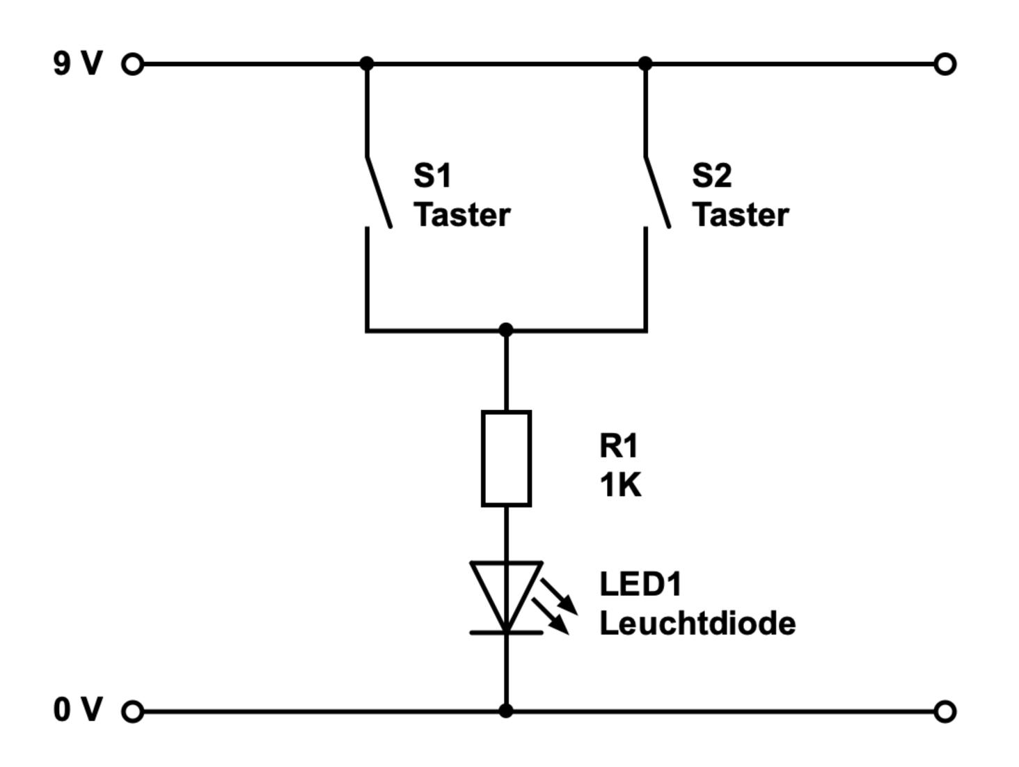
Eine ODER-Schaltung ist eine Schaltung, deren Funktion auf die Erfüllung einer Bedingung beruht. WENN "Bedingung" erfüllt, DANN "Funktion".
