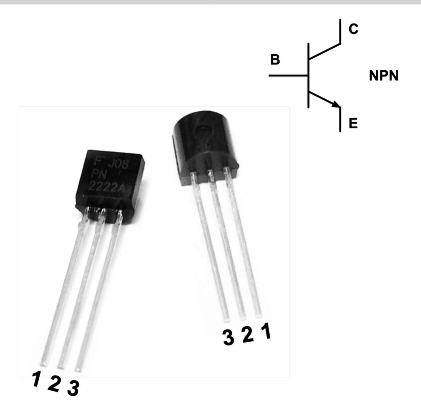
Die Belegung der Pins der Transistoren ist unterschiedlich. Tendenziell ist der mittlere Anschluss die Basis (B). Die beiden Anschlüsse an der Seite sind bei jedem Transistor anders. Wenn Du Dir nicht sicher bist, dann probiere es einfach aus. In der Regel wird man mit einer Falschpolung nichts kaputt machen. Transistoren sind aufgrund der kleinen Bauform nur mit der Typennummer gekennzeichnet. Das ist eine Kombination aus Buchstaben und Zahlen, die aber keine weitere Bedeutung haben.
