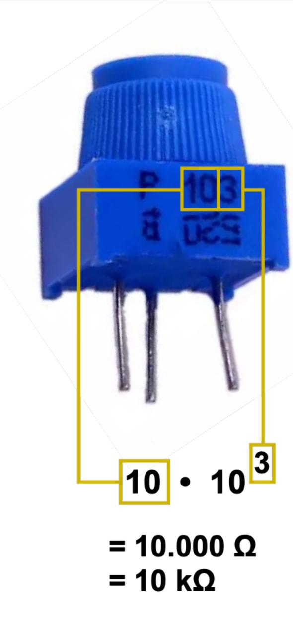
Manchmal ist auf dem Potentiometer der Widerstandswert aufgedruckt. Manchmal ist die Kennzeichnung kodiert, also eine Kurzform. Dann sind die ersten zwei Ziffern der Wert in Ohm. Eine dritte Ziffer ist der Multiplikator, also die Anzahl der Nullen, die man dem Wert anfügt. Ab drei Nullen rechnet man in Kiloohm (kOhm) um.
