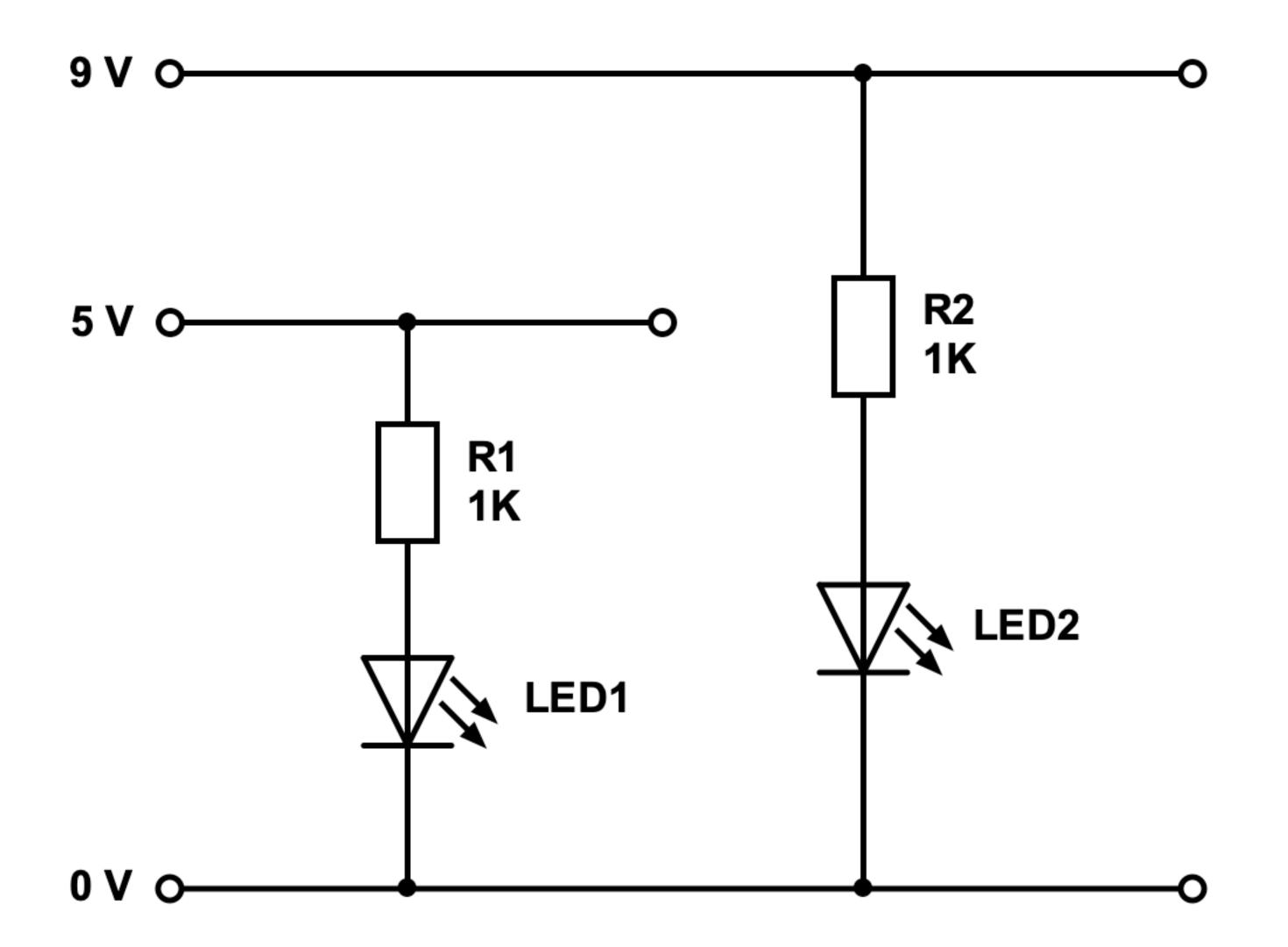
Bei dieser Schaltung haben wir zwei identische Stromkreise mit Vorwiderstand und Leuchtdiode. Der Unterschied ist nur die unterschiedliche Betriebsspannung.
