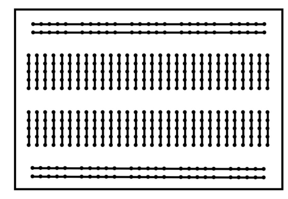
Die durchgezogenen Linien kennzeichnen die Steckkontakte, die elektrisch verbunden sind und daher den Strom leiten.
