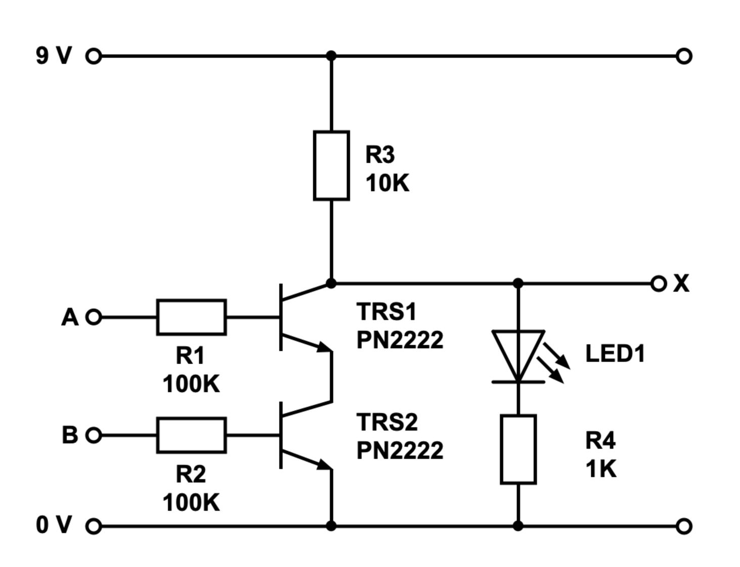
Eine NICHT-UND-Schaltung (NAND) ist eine Schaltung, deren Funktion auf die Erfüllung einer Bedingung beruht. WENN "Bedingung" erfüllt, DANN "Funktion".
