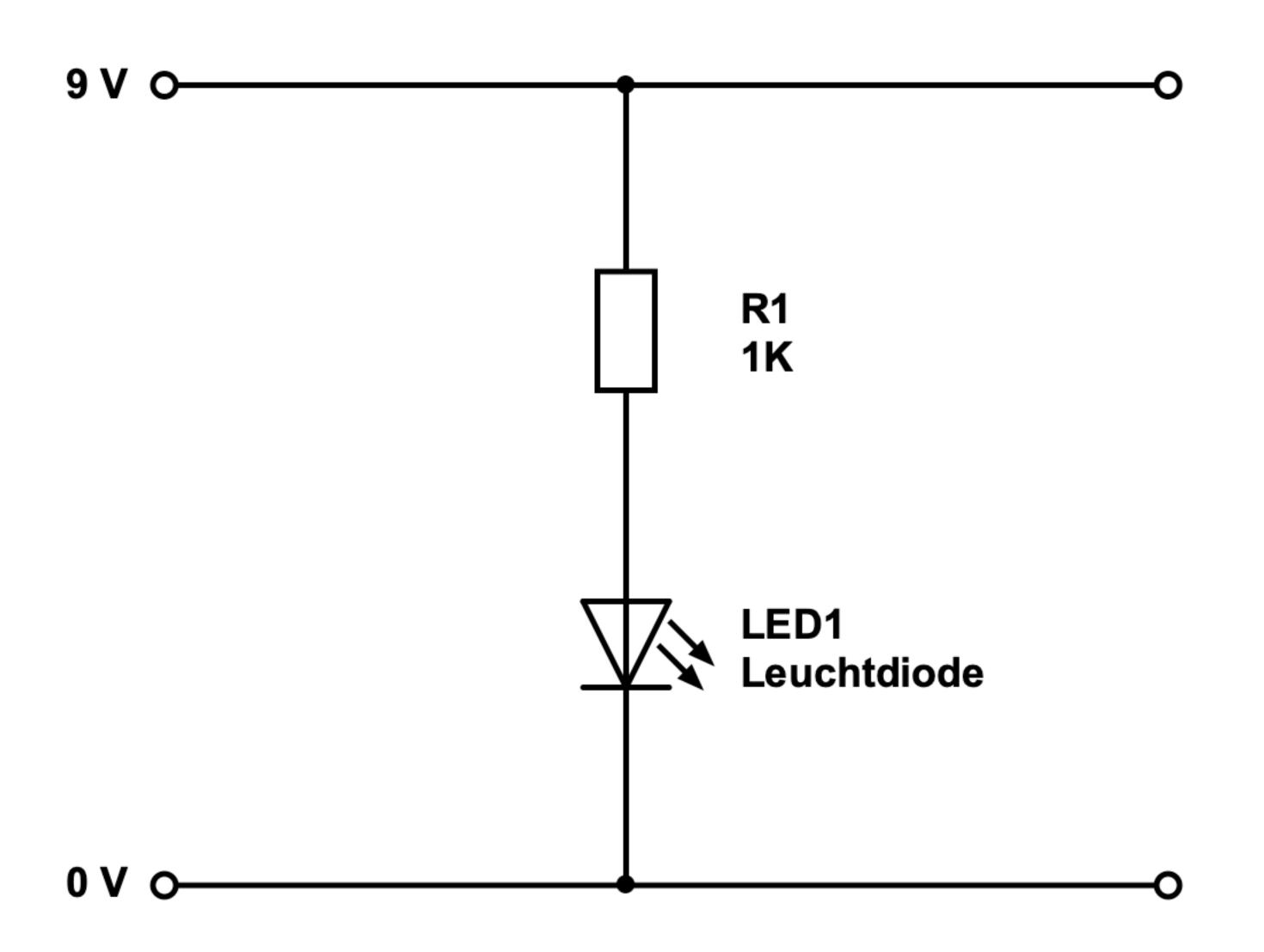
Ein einfacher Stromkreis setzt sich aus einem (Leistungs-) Erzeuger (einer Spannungs- bzw. einer Stromquelle) und einem (Leistungs-) Verbraucher zusammen, die über Leitungen miteinander verbunden sind.
