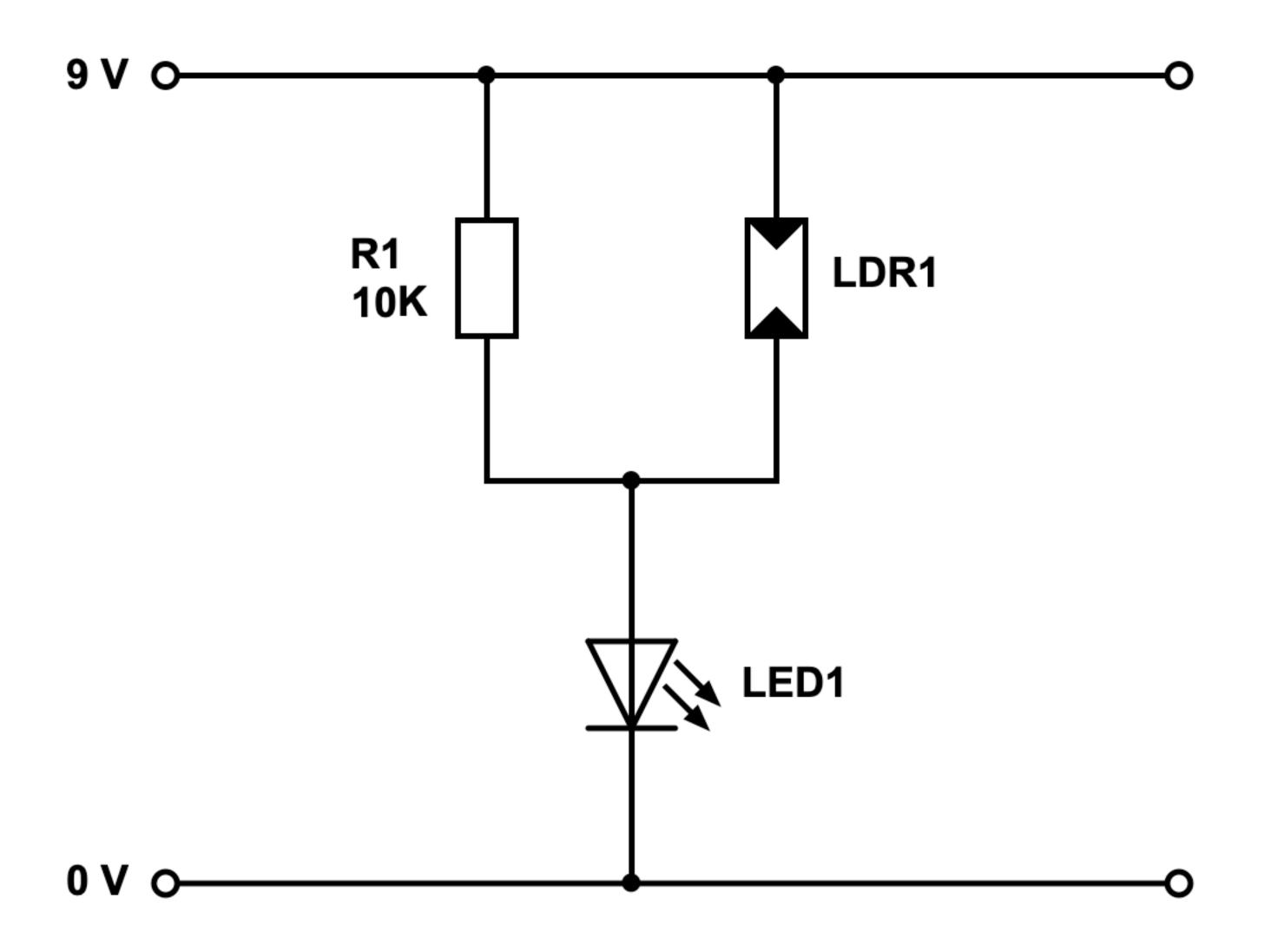
Wir wollen herausfinden, wie sich ein Fotowiderstand, kurz LDR genannt, in einem einfachen Stromkreis verhält. Hierzu lässt sich vorab schon mal sagen, dass der Widerstandswert eines Fotowiderstands von der Helligkeit des einfallenden Lichts abhängig ist. Aber, wie genau wirkt sich das zum Beispiel auf die anderen Bauteile im selben Stromkreis aus?
