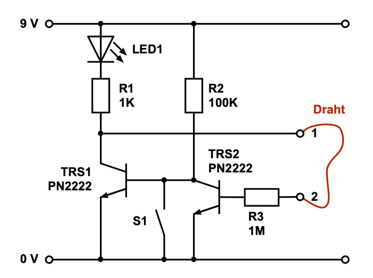
Diese Schaltung ist eine Alarmschaltung, bei der die LED dann leuchtet, wenn eine Verbindung oder ein Kontakt im Steuerstromkreis des Transistors geöffnet oder unterbrochen wird. Eine Besonderheit ist die Selbsthaltung des Alarmzustands. Der Alarmzustand bleibt auch dann erhalten, wenn der Kontakt wieder geschlossen wird.
