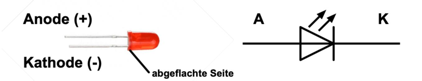
Je nach Hersteller, Farbe und Typ können Leuchtdioden sehr unterschiedliche elektrische Werte aufweisen. Gemeint sind die Durchlassspannung und der Durchlassstrom. Beide Werte sind wichtig zur Berechnung des strombegrenzenden Vorwiderstands.
