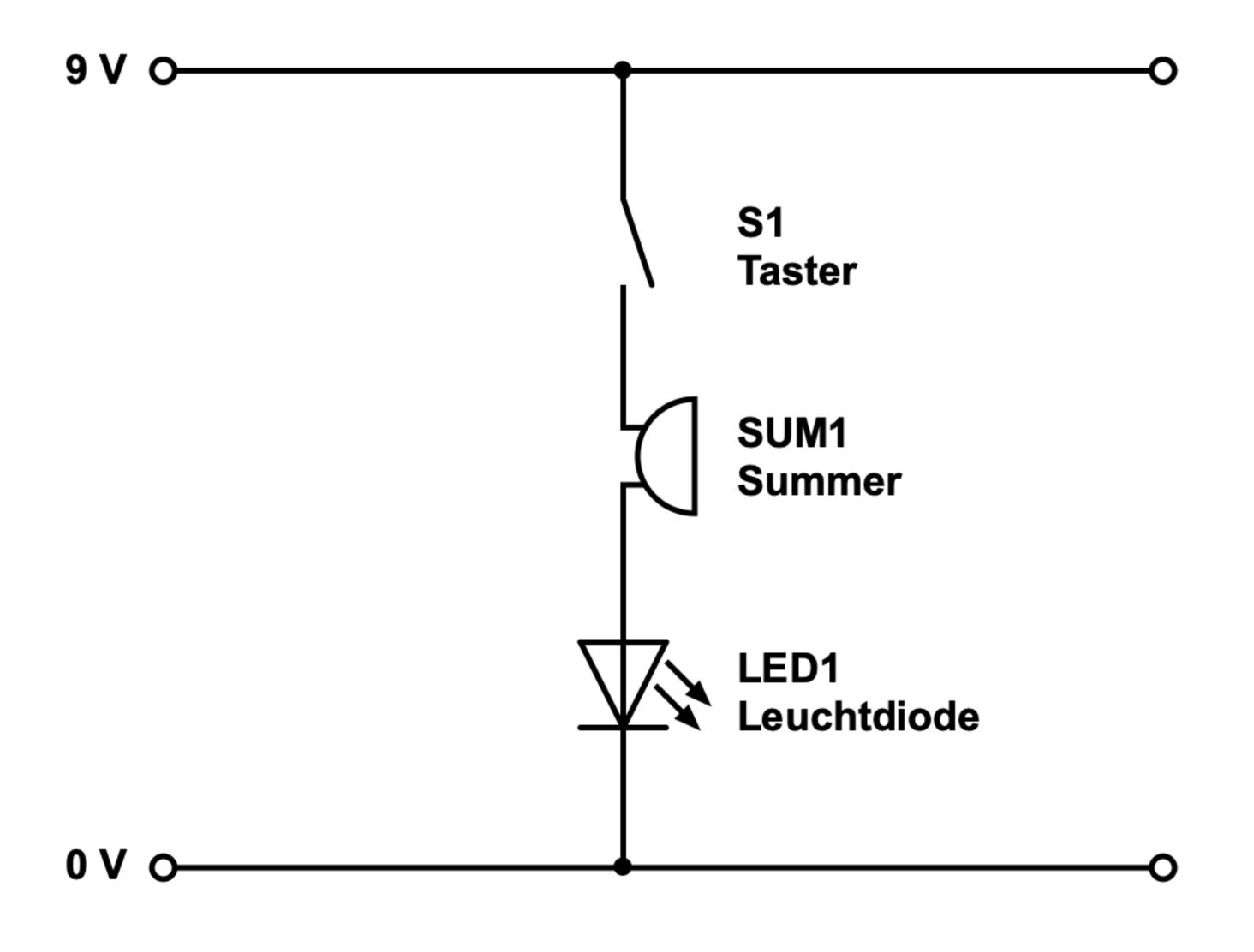
Was kann man bei einem Summer schon falsch machen? Naja, Du kannst ihn richtig oder auch falsch herum in die Schaltung einbauen. Ein Summer ist gepolt. Zur Unterscheidung der Anschlüsse ist der Summer auf dem Gehäuse mit einem Plus (+) gekennzeichnet.
