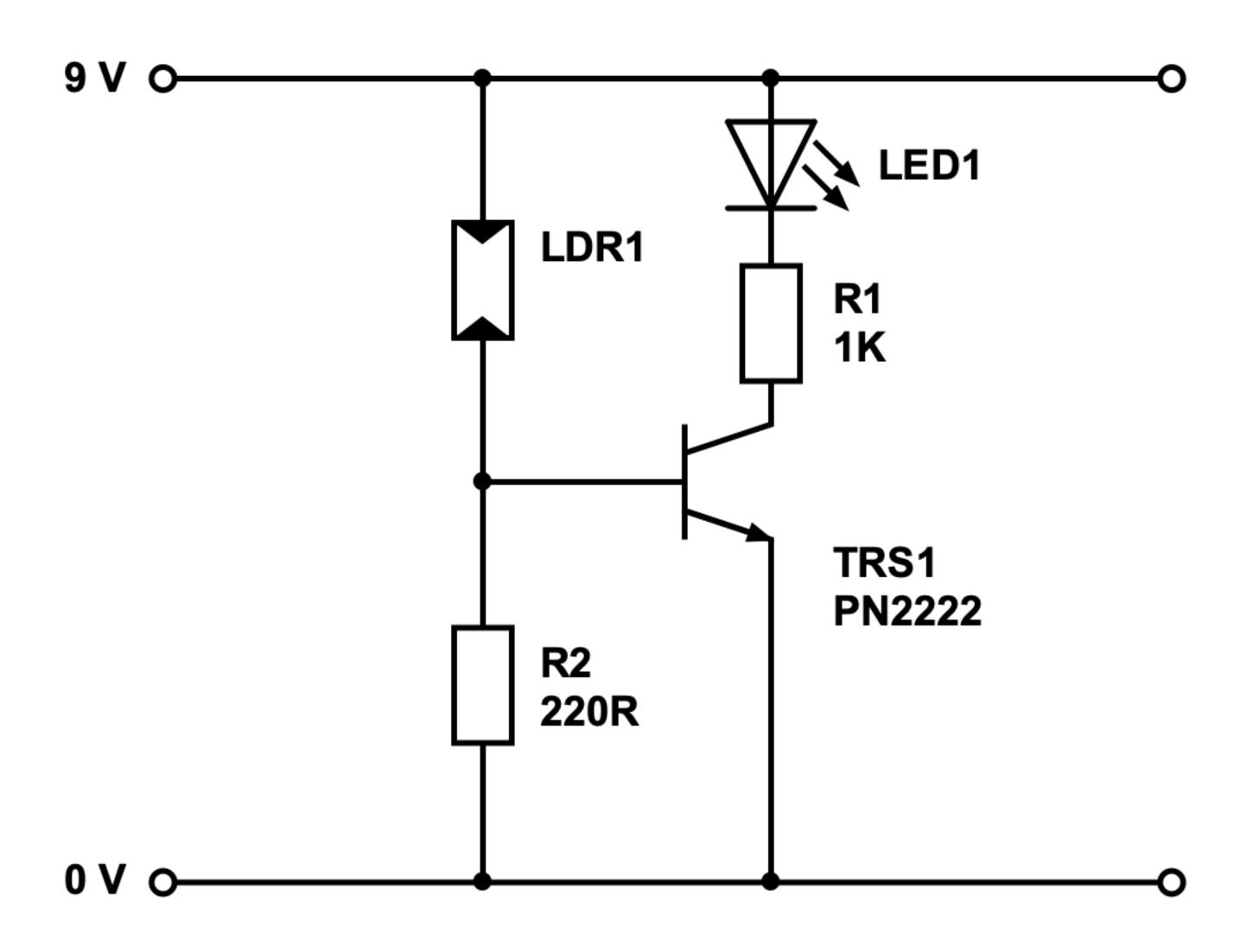
Eine Tagschaltung ist eine Schaltung, bei der eine Leuchtdiode leuchtet, wenn Licht an ist bzw. Helligkeit erkannt wird. Der Helligkeitssensor ist in diesem Fall ein Fotowiderstand (LDR). Wir wollen herausfinden, wie sich eine Tagschaltung verhält.
