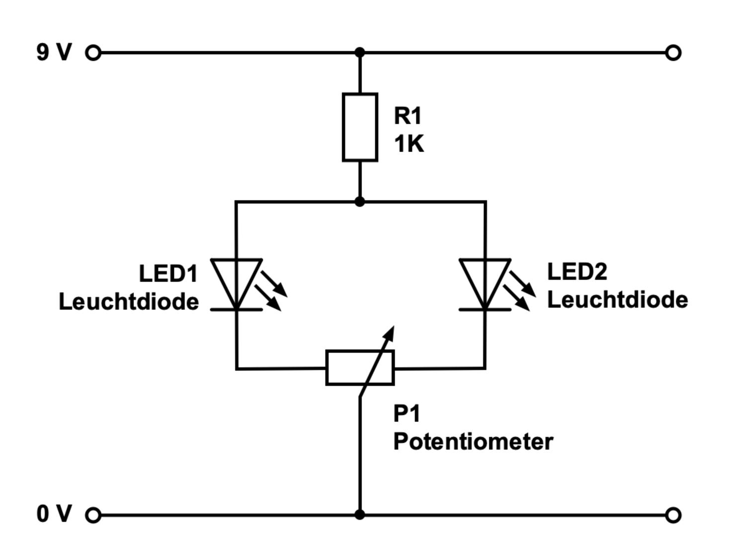
Das Parallelschalten von Leuchtdioden mit einem gemeinsamen Vorwiderstand funktioniert nicht immer. Was am unterschiedlichen Spannungsbedarf liegt. Mit einem zusätzlichen Potentiometer befindet sich für jede Leuchtdiode ein variabler Vorwiderstand im Stromkreis, wodurch sich für beide Leuchtdioden unterschiedliche Spannungen und Ströme einstellen können.
