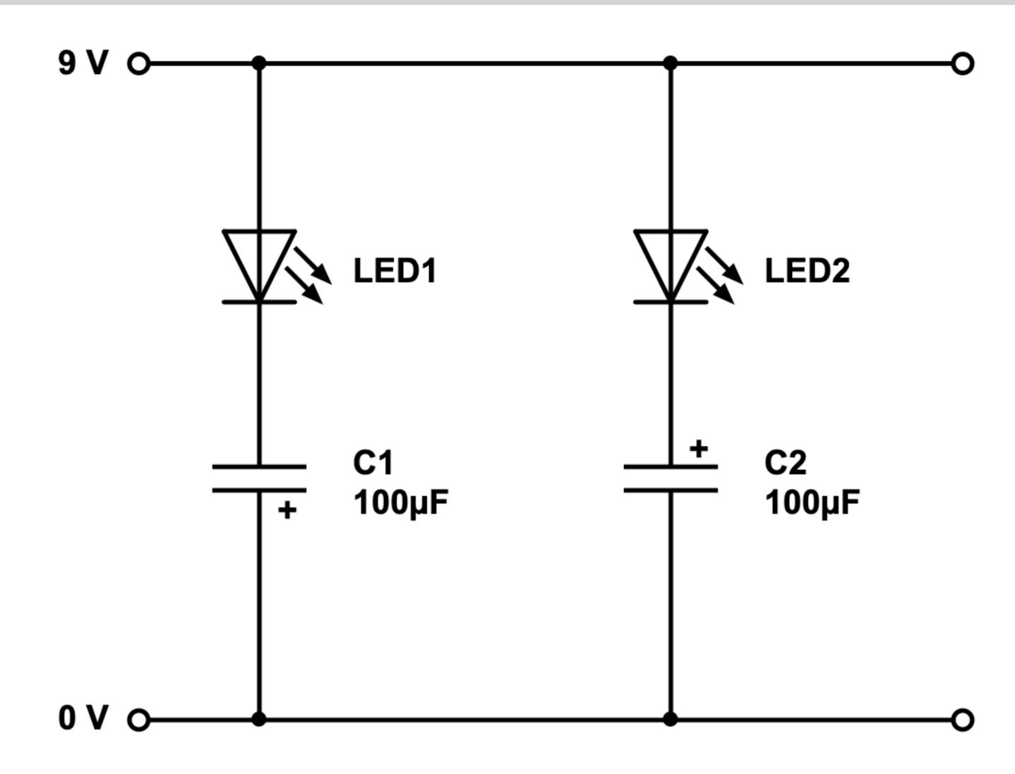
Wir wollen herausfinden, wie sich ein Elektrolyt-Kondensator, kurz Elko genannt, in einem einfachen Gleichstromkreis verhält. Zum Vergleich bauen wir den Elektrolyt-Kondensator unterschiedlich gepolt in den Stromkreis zusammen mit jeweils einer Leuchtdiode ein.
