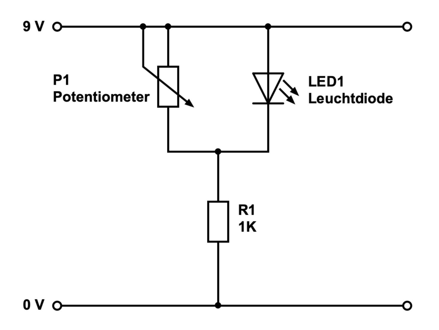
Wir wollen herausfinden, wie sich ein Potentiometer in einem einfachen Stromkreis verhält. Hierzu lässt sich vorab schon mal sagen, dass ein Potentiometer ein einstellbarer Widerstand ist, und man damit den Strom in einem Stromkreis einstellen kann. Aber, wie genau wirkt sich das zum Beispiel parallel zu einer Leuchtdiode aus? Und lässt sich das auch sinnvoll nutzen?
