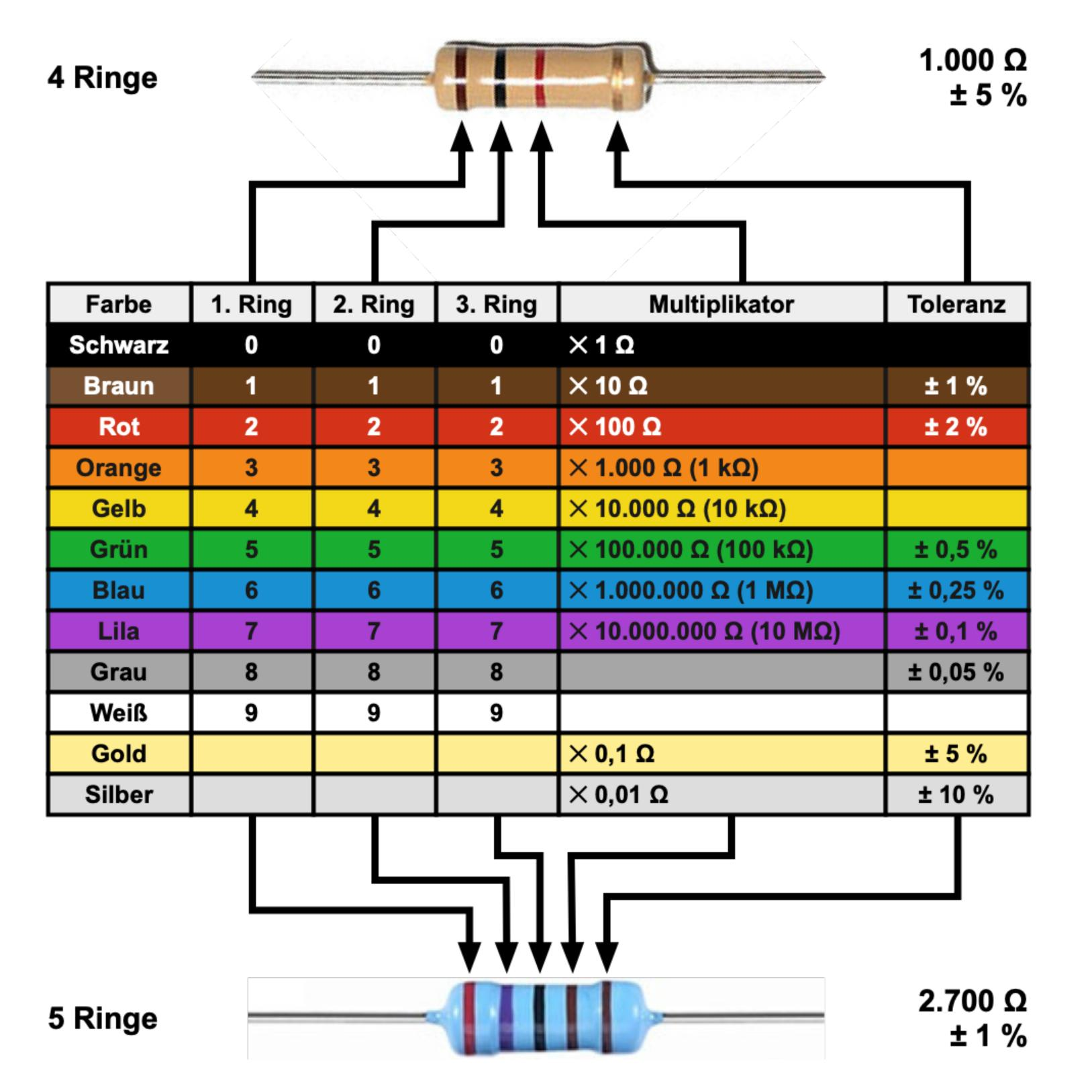
Widerstände werden in der Regel durch Farbringe gekennzeichnet. Je nach Art des Widerstandsmaterials, werden 4 oder 5 Ringe verwendet.
