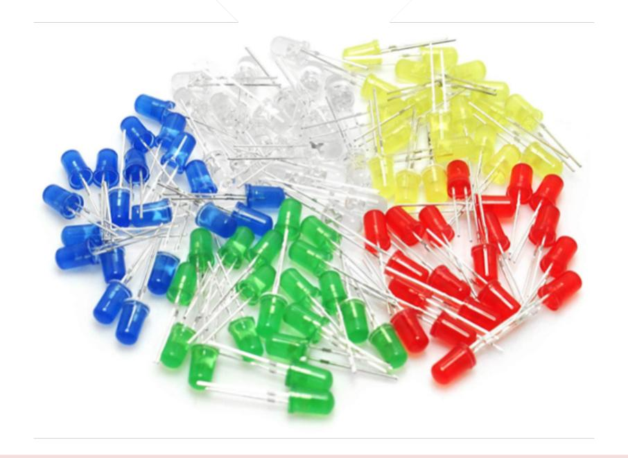
Leuchtdioden werden typischerweise mit einem Vorwiderstand in Reihe betrieben, der eine spannungs- und strombegrenzende Wirkung hat. Die Strombegrenzung ist deshalb notwendig, weil der LED-Halbleiter bei zu viel Strom kaputt gehen kann.
