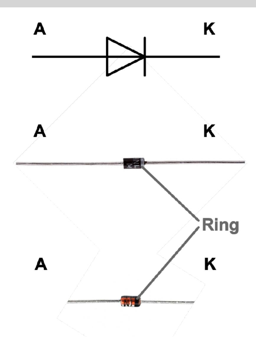
Eine Diode hat zwei Anschlüsse. Den einen Anschluss bezeichnet man als Anode, den anderen als Kathode. Die Kathode erkennt man an dem Ring auf dem Gehäuse der Diode.
