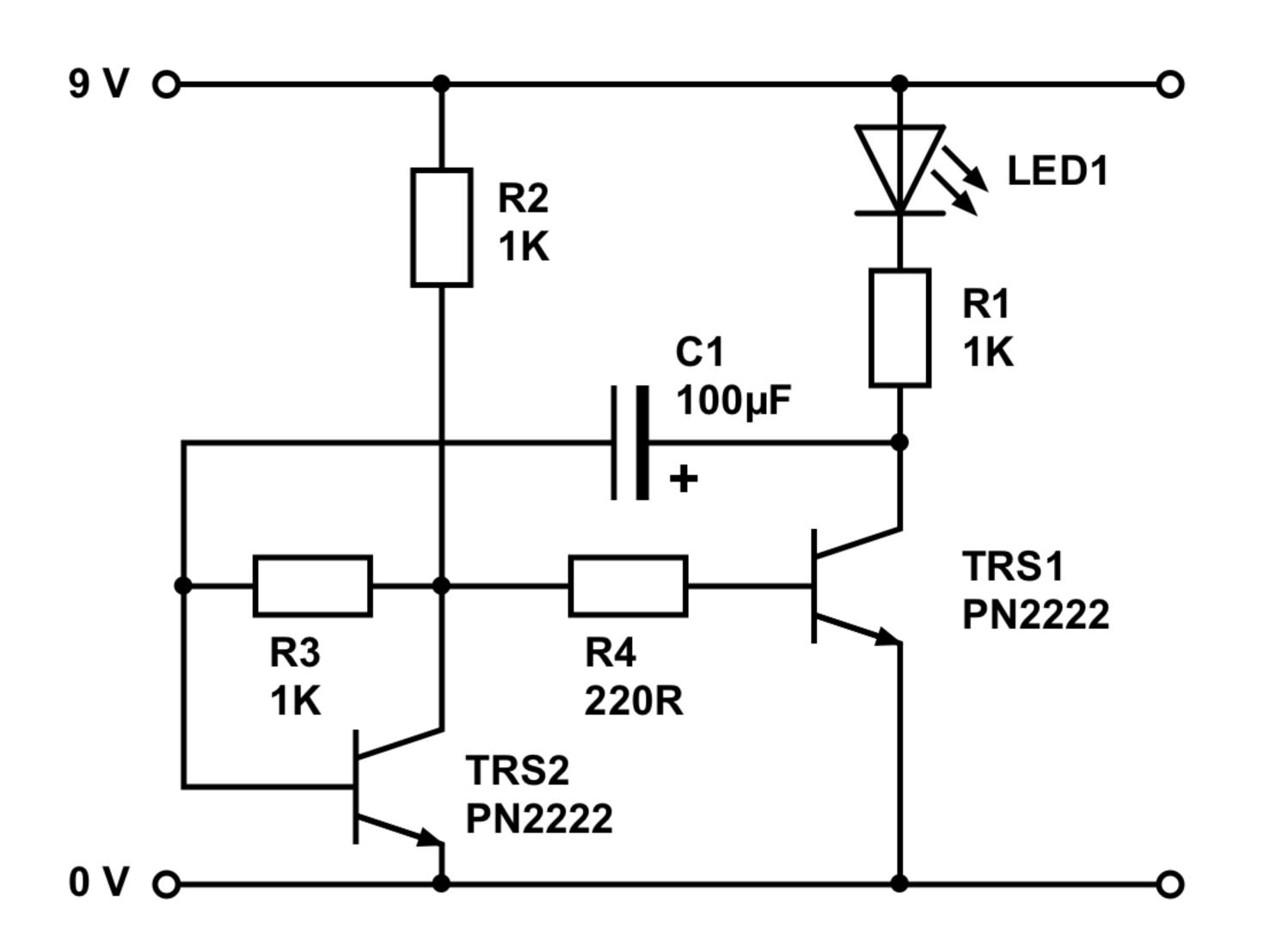
Diese LED-Blinker-Schaltung ist die einfachste Schaltung mit vergleichsweise wenigen Bauteilen, bei der von sich aus etwas passiert und die zum Ausprobieren und Experimentieren einlädt.
