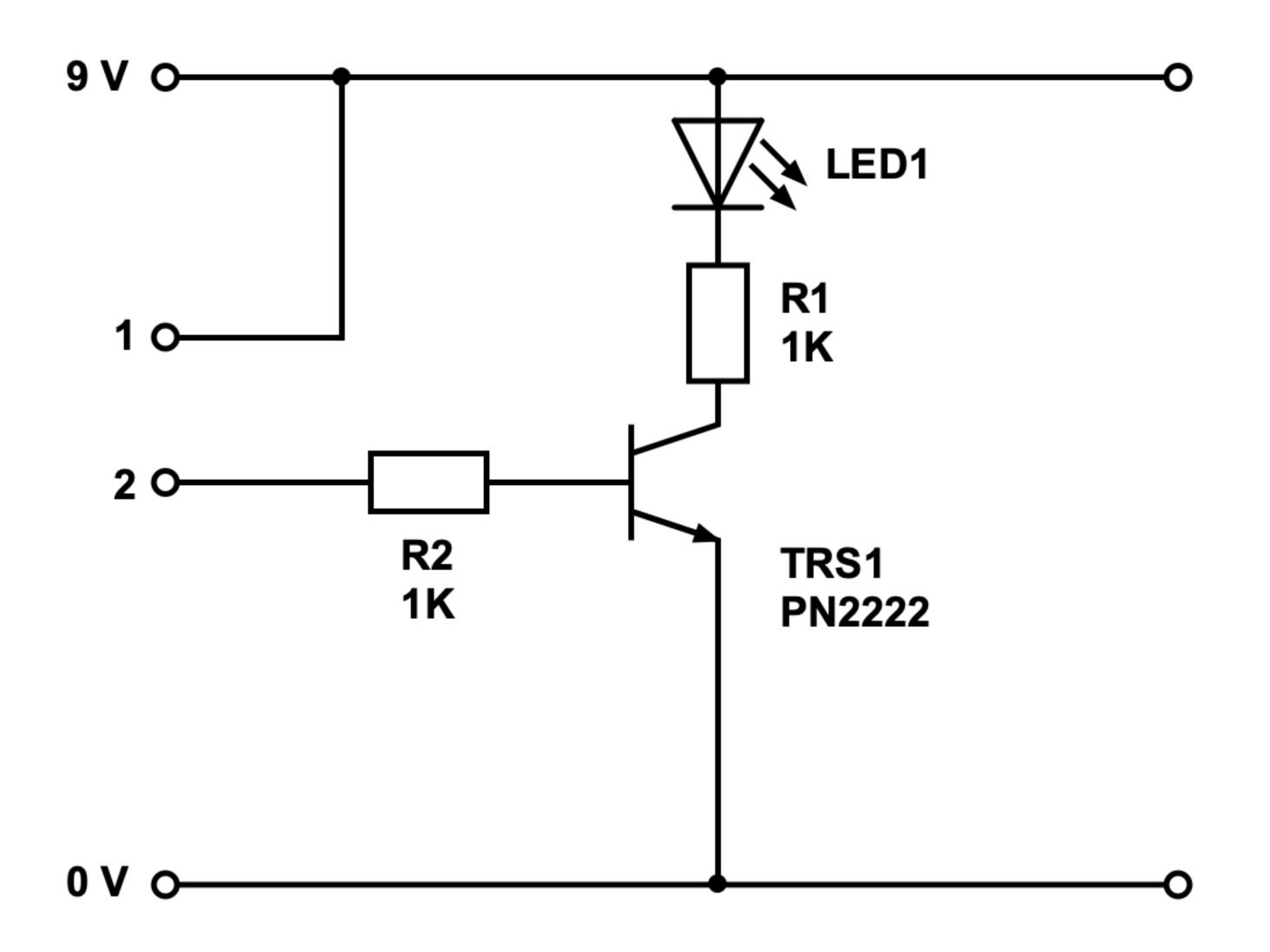
Der Bauteil-Tester eignet sich zum Prüfen von Widerständen, Kondensatoren, Dioden, Leuchtdioden und Transistoren. Ebenso ist er als einfacher Berührungssensor oder Durchgangsprüfer nutzbar. Zur Signalisierung wird eine Leuchtdiode verwendet.
