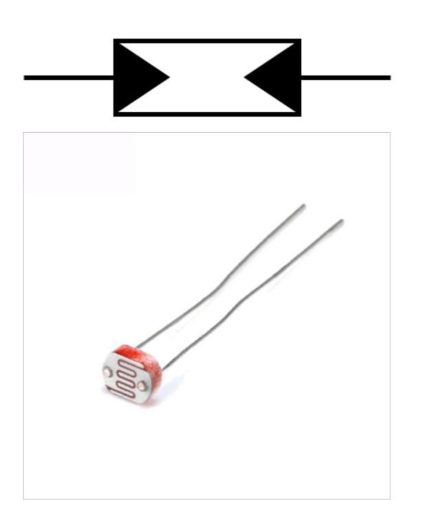
Je mehr Licht, desto kleiner der Widerstand, desto größer der Strom und geringer der Spannungsabfall.
