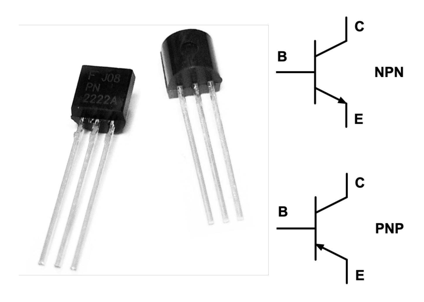
Der Strom durch einen Transistor muss begrenzt werden. Ein zu großer Strom durch den Basis- oder Kollektor-Anschluss zerstört den Transistor. Zur Begrenzung eignen sich Widerstände.
