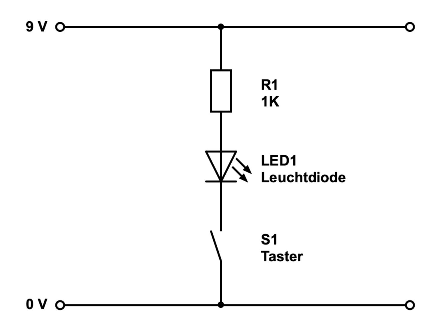
Diese Schaltung ist ein einfacher Stromkreis mit einer Batterie als Spannungsquelle bzw. Leistungserzeuger und einer Leuchtdiode mit Widerstand als Verbraucher. Mit Druck auf den Taster kann man den Stromkreis schließen und öffnen und damit die LED einschalten bzw. ausschalten.
