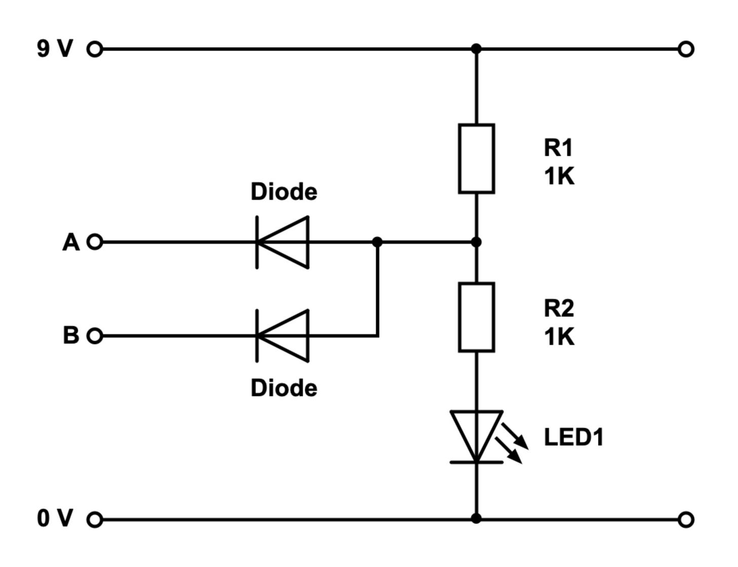
Eine UND-Schaltung ist eine Schaltung, deren Funktion auf die Erfüllung einer Bedingung beruht. WENN "Bedingung" erfüllt, DANN "Funktion".
