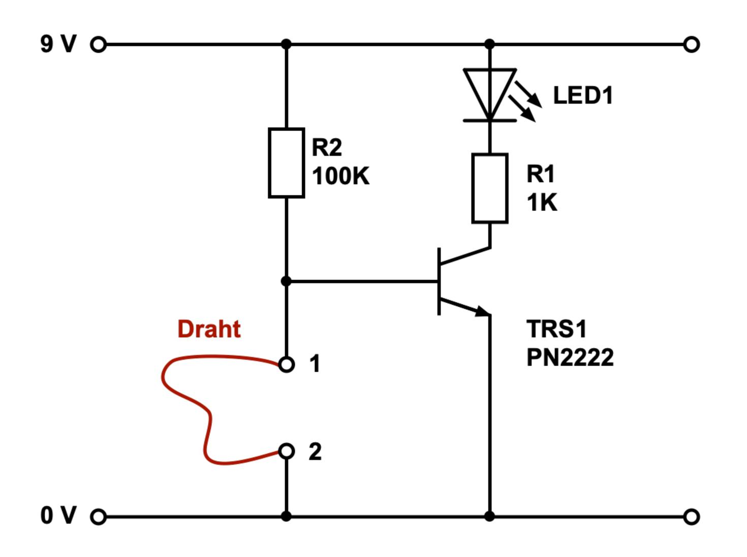
Diese Schaltung ist eine ganz einfache Alarmschaltung, bei der die LED dann leuchtet, wenn ein Kontakt im Steuerstromkreis des Transistors geöffnet oder unterbrochen wird. Die Besonderheit dieser Schaltung ist, dass sie andersherum funktioniert als bei anderen Transistor-Schaltungen.
