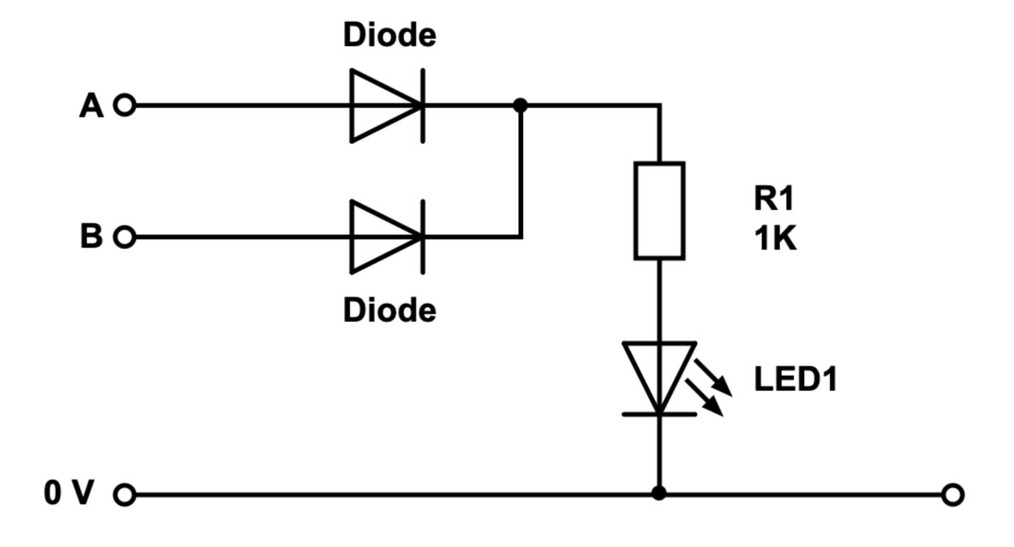
Eine ODER-Schaltung ist eine Schaltung, deren Funktion auf die Erfüllung einer Bedingung beruht. WENN "Bedingung" erfüllt, DANN "Funktion".
