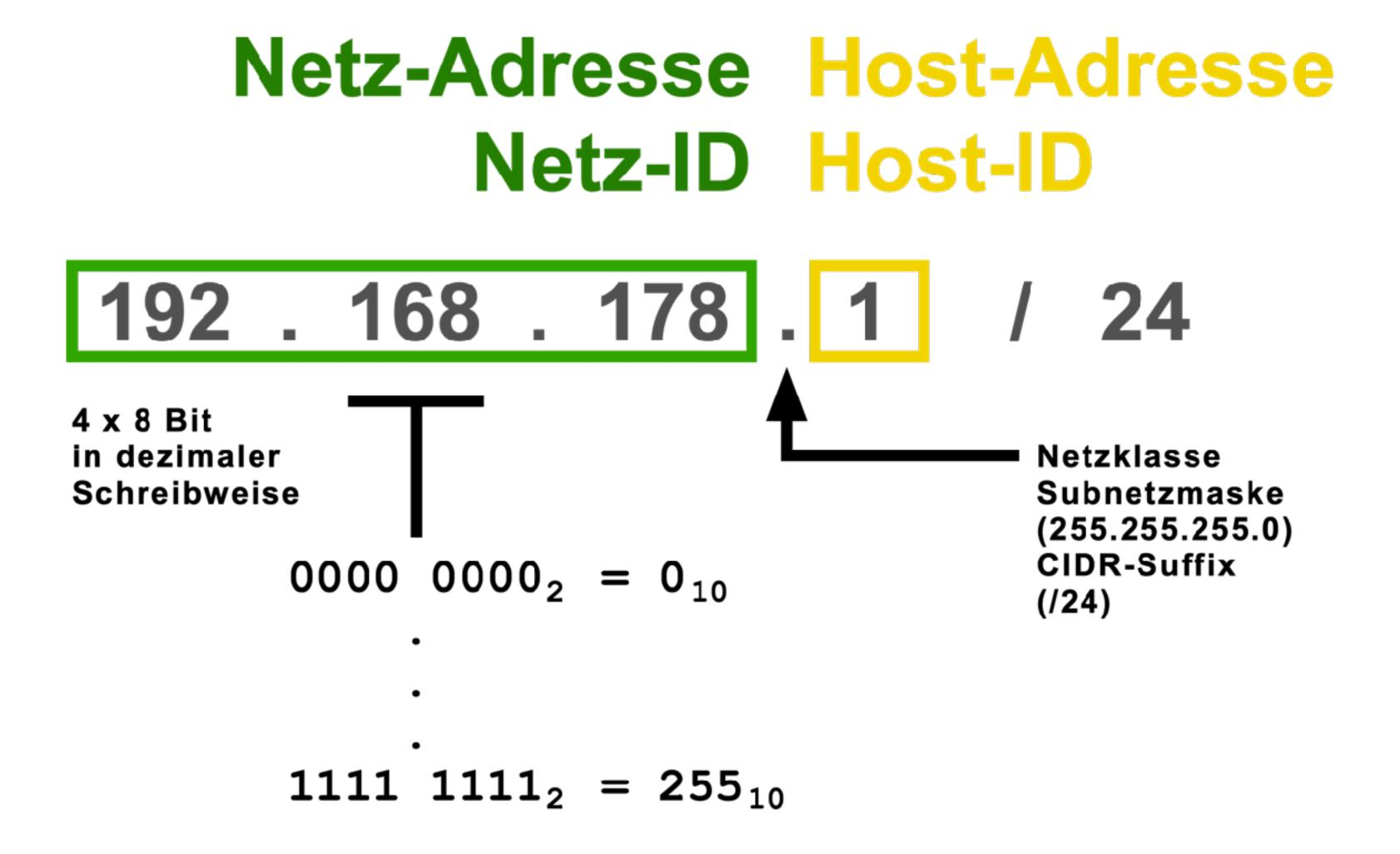
Um an einem IPv4-Netzwerk teilnehmen zu können, benötigt jeder Host eine IPv4-Konfiguration. Teil der IPv4-Konfiguration ist ein eindeutige IPv4-Adresse, die eine Voraussetzung für die Teilnahme an einem IP-Netzwerk ist. Jedes Datenpaket wird mit der IPv4-Adresse von Absender und Empfänger adressiert.
