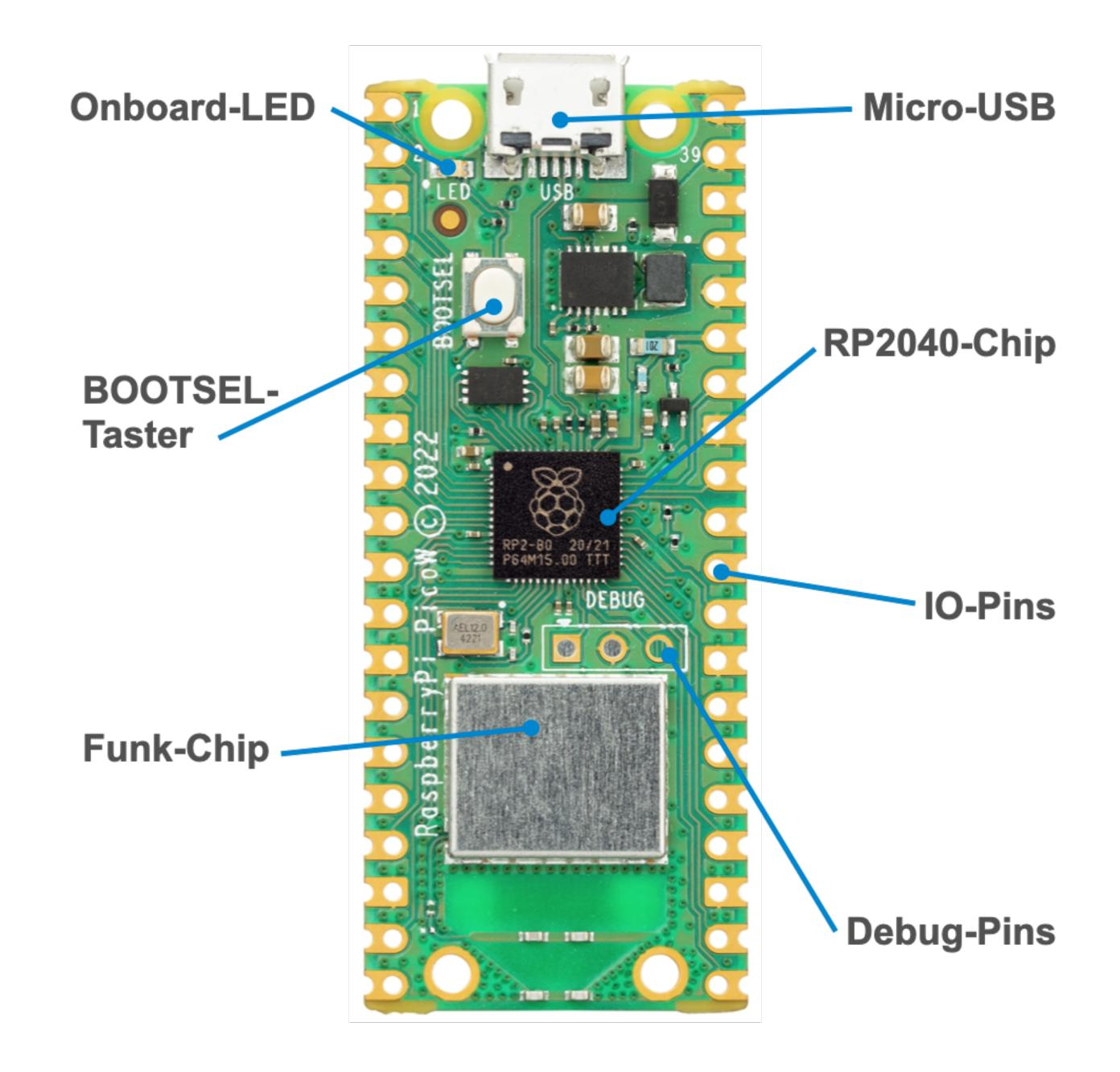
Der Pico wird über ein USB-Kabel mit einem Computer verbunden. Der Pico wird dabei mit Strom versorgt und meldet sich dann am Computer an. Die Programmierung erfolgt über eine virtuelle serielle Schnittstelle.
