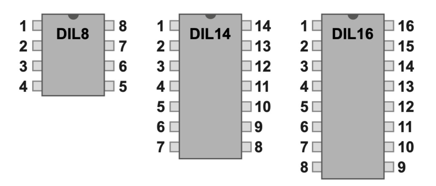
Wenn man auf die beschriftete Seite des ICs schaut, kann man an einer kurzen Seite eine Einkerbung entdecken. Diese Einkerbung kennzeichnet "oben". Links von der Einkerbung beginnt die Nummerierung der Pins von 1 an nach unten gegen den Uhrzeigersinn zu zählen.
