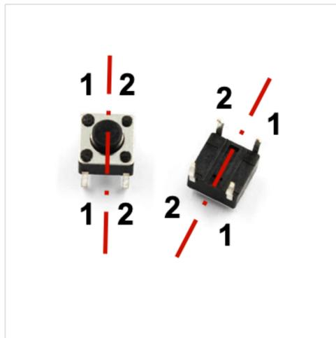
Die im Bild mit 1 und 2 gekennzeichneten Anschlüsse können je nach Bauform an unterschiedlichen Positionen liegen. Welche Anschlüsse zusammengehören, muss man mit einem Durchgangsprüfer oder Widerstandsmessgerät herausfinden.
