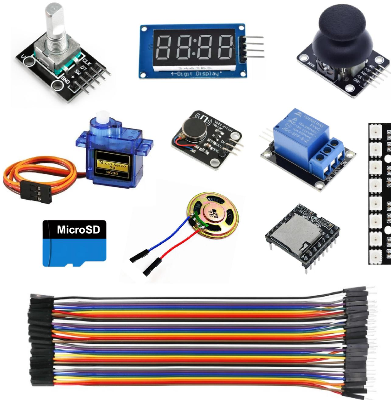
Das Elektronik-Set Eingabe Ausgabe Edition ist eine Sammlung beliebter Bauteile zur Dateneingabe, Steuerung und Datenausgabe für die Hardware-nahe Programmierung mit Mikrocontrollern und Mini-Computern.
